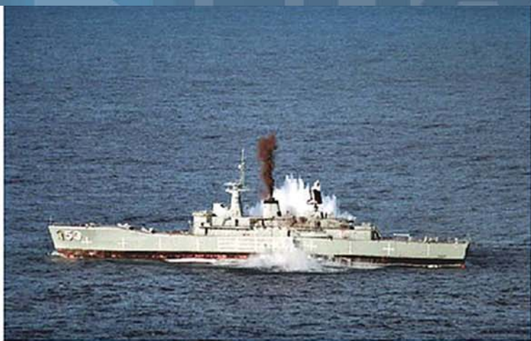
Дејство торпеда Mk48 ADCAP на разарачу. Бојна глава експлодира испод брода, чиме се брод дословце преполови.
